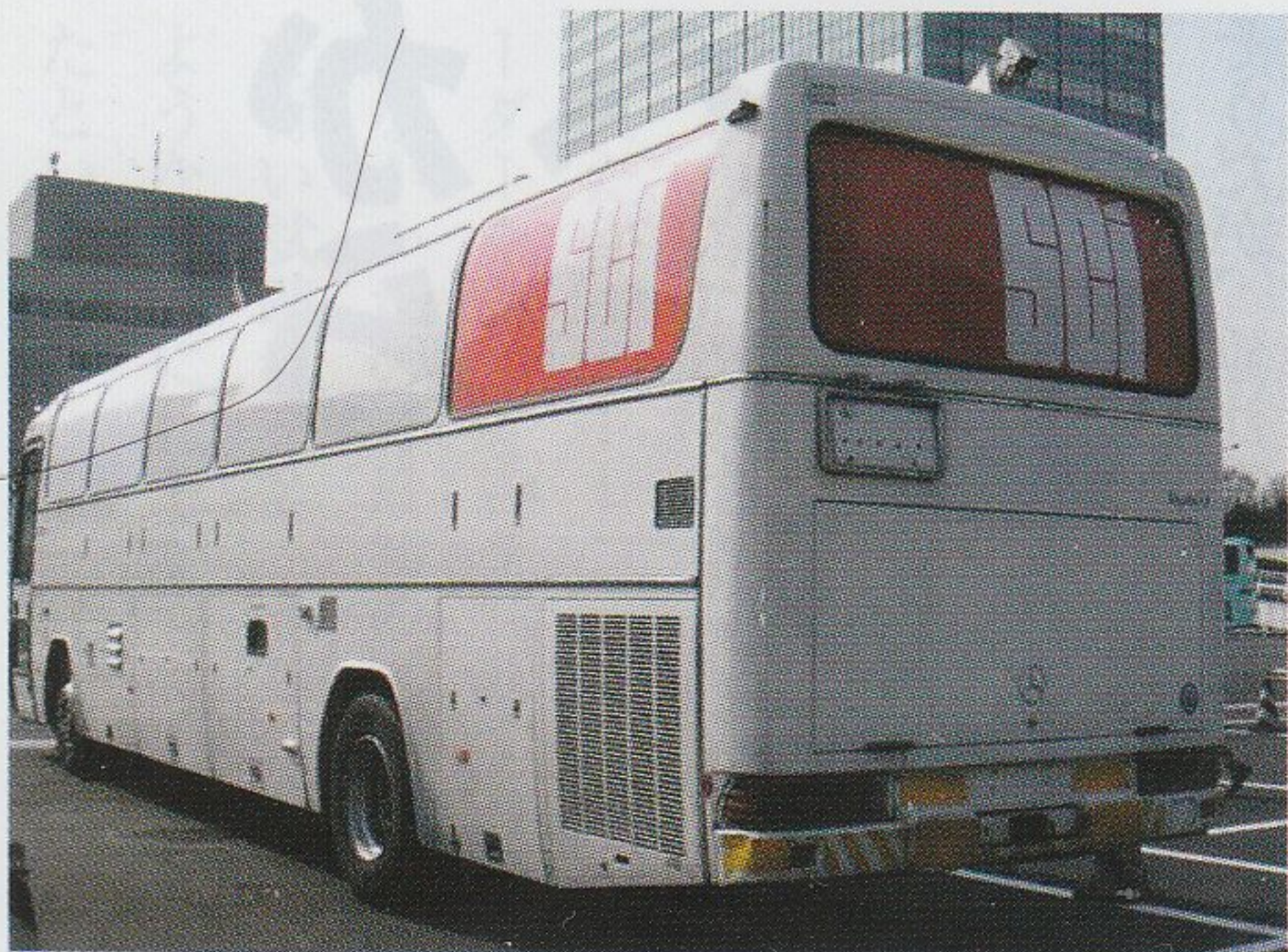
SCIが所有する大型録音中継車の1台。コンソ ールはNEVE VR 48-48とSSL C200、モニタースピー カーはYAMAHA NS-10MとGENELEC 8040A を搭載している
