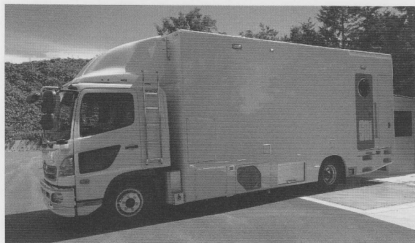
SCI 8号車の外観 全長8,590×全幅2,490×全高3,400mm。総重量:7.9t
